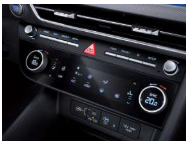
Екі аймақтық климатты бақылау (әйнектің булануын жою функциясымен)
