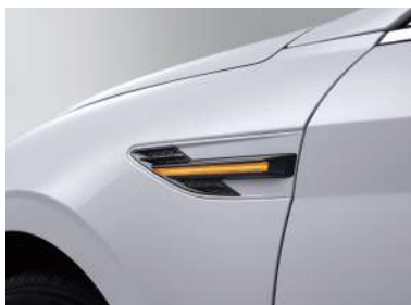
Қанаттардағы бұрылыс көрсеткіштерін жарықдиодты қайталағыштар
